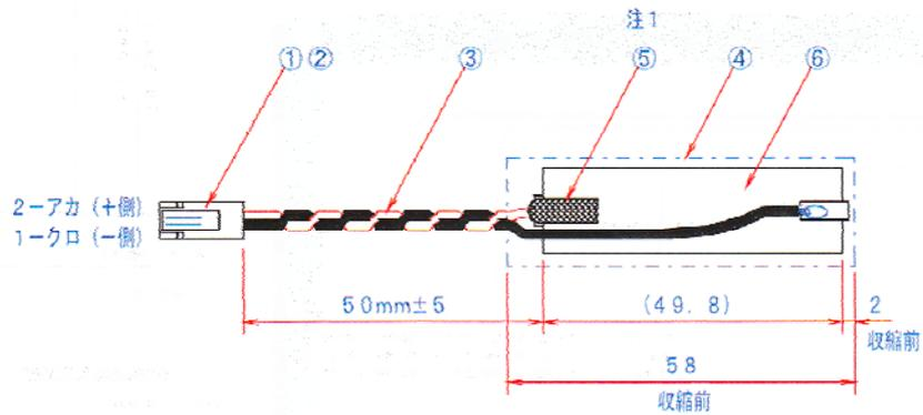
注1: ⑤の収縮チューブは、+側の電極まで被せる。(+側のみ)
