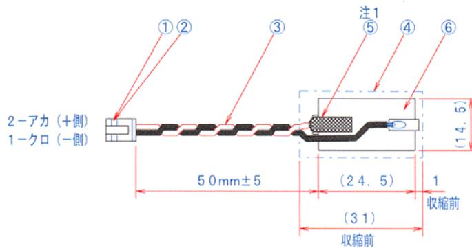
注1：⑤の収縮チューブは、+側の電極まで被せる。(+側のみ)
